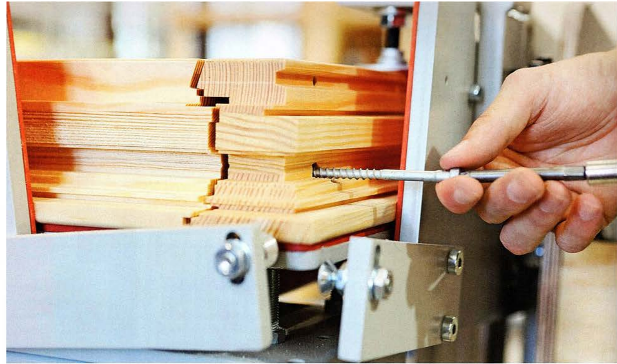
! Mithilfe der MC2-Schraube wird die Eckverbindung zusammengezogen. Das Sondergewinde verankert sich parallel zur Faser, der Schraubenschaft zieht sich passgenau in die MC2-Hülse.
