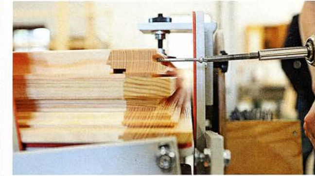
/ Der MC1-Verbinder wird im 90°-Winkel zu den Holzfasern verschraubt. Die Verankerung im Hirnholz erfolgt dadurch parallel zur Faser.
