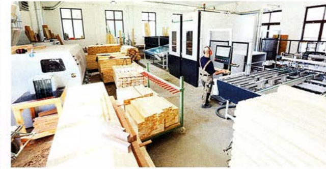
! Auf dem neuen Conturex-Bearbeitungscenter werden die Löcher für das MC-System präzise gebohrt.
